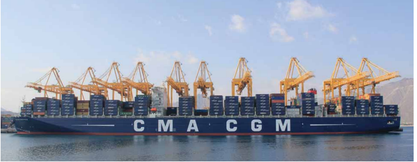
محطة حاويات غلفتينر في ميناء خورفكان هي أول محطة في الإمارات العربية المتحدة تستقبل سفينة "ماركو بولو" - أكبر سفينة حاويات في العالم (16.000 وحدة مكافئة لعشرين قدماً) - وتم تفرغها باستخدام 10 رافعات قطرية متحركة في يناير 2013
